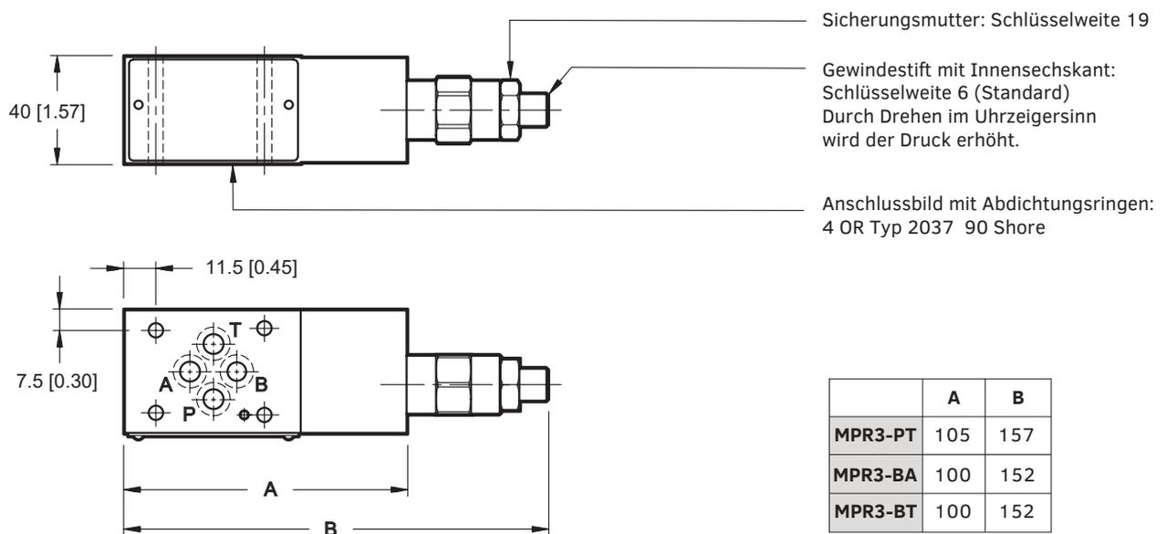
**MPZ3 - DIREKTGESTEUERTES DRUCKREDUZIERVERTIL**
